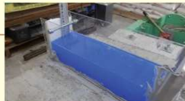
【実物大供試体水張試験】漏水なし
