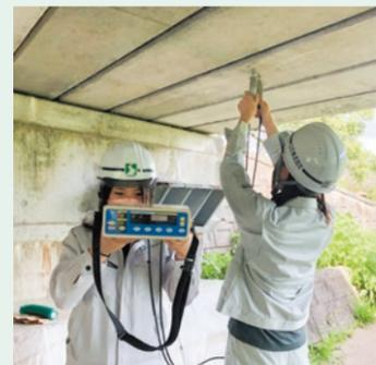
薬剤の注入前後に、超音波測定器を用いて、ひび割れに注入されているかの確認を行っている。
